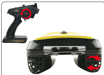
C. Otočte volant řízení proti směru hodinových ručiček, levý lodní šroub stojí a pravý se otáčí ve směru dle obrázku. Takto se ovládá zatáčení doleva.
