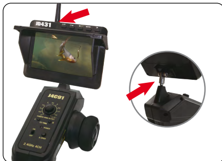
F. Na vysílač upevněte monitor dle obrázku. Monitor zapněte.
