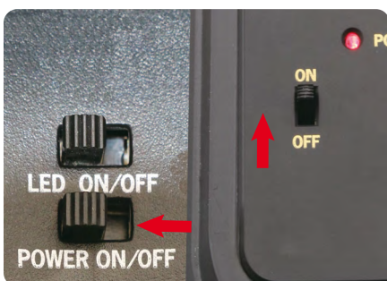
E. Nejprve zapněte vysílač (červená LED na vysílači svítí) a potom zapněte vypínač „POWER“ na skříňce přijímače (modrá LED na skříňce přijímače svítí).
