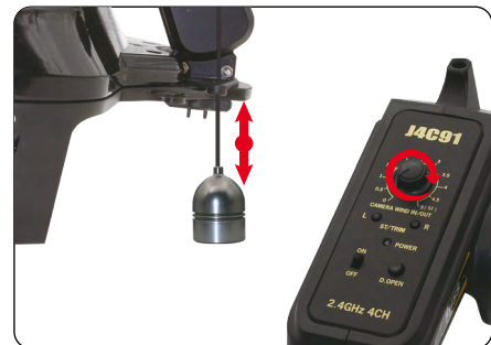
I. Pomocí knoflíku na vysílači „CAMERA WIND IN/OUT) můžete navíjet a odvíjet lano kamery. Celková délka lana je 5,5 m, ovládaná délka odvinutí/navinutí je 5 m.
