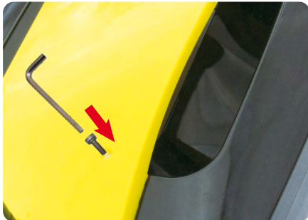
G. Držadlo lodi nasadíte na místo a upevníte 6 imbusovými šrouby.
