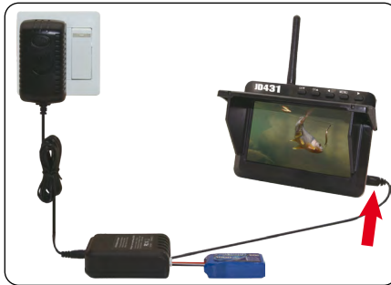
A. Nabíjení akumulátorů navijáku kamery a displeje.
