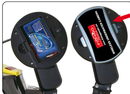
G. Do prostoru uvnitř navijáku lana kamery vložte a připojte akumulátor dle obrázku a kryt uzavřete.
