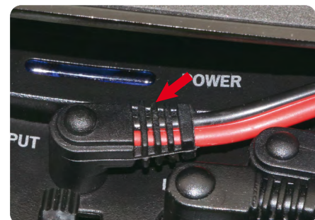
C. S pomocí konektoru dodávaného s lodí připojte napájecí kabel převodníku. Černý vodič je záporný pól (-) na vnějším plášti konektoru, hnědý vodič je kladný pól (+) v dutince konektoru. Konektor napájení zapojte do zásuvky „OUTPUT 12V/1A“ na skřínce přijímače. POZOR: Předem se ujistěte, že váš vyhledávač ryb/sonar je konstruován pro 12 V napájení.
