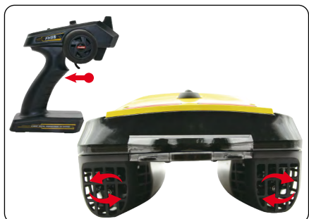
A. Stiskněte spoušť ovladače plynu, levý i pravý lodní šroub se roztočí ve směru dle obrázku. Takto se ovládá jízda vpřed, rychlost otáčení lodních šroubů (a tím pádem rychlost lodi) je úměrná tomu, do jaké míry ovladač vychýlíte směrem k sobě.
