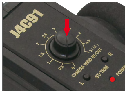
G. Otočný knoflík na vysílači slouží pro ovládání bezdrátové ponorné kamery (tuningové příslušenství, není součástí základní sady lodi). Pokud nemáte kameru nainstalovanou, knoflík nemá žádnou funkci.
