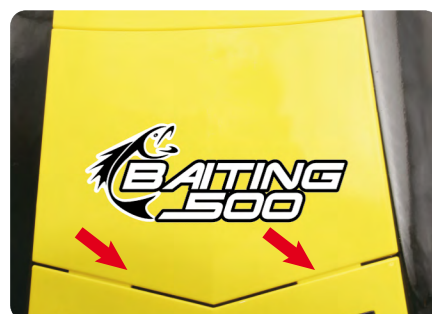
G. Dle obrázku znovu upevněte kryt. Dva výstupky na krytu zasuňte do drážek na lodi.
