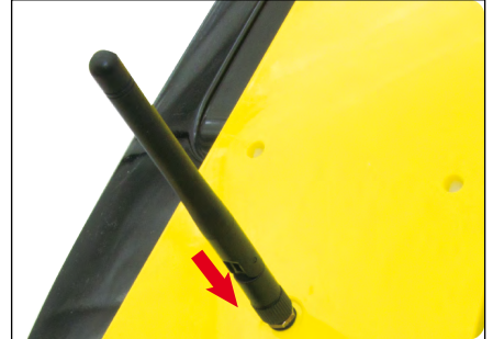
I. Do konektoru upevníte anténu. Tím je instalace vyhledávače ryb/sonaru dokončena.
