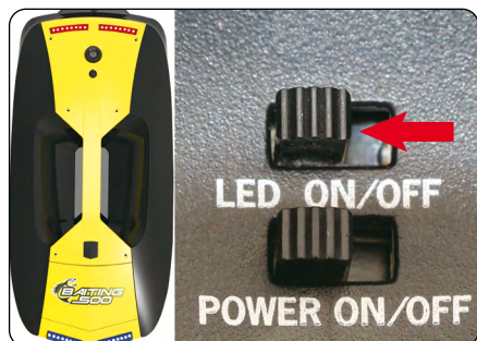
E. Zapněte vypínač „LED“, přední modré LED a zadní červené LED se rozsvítí.
