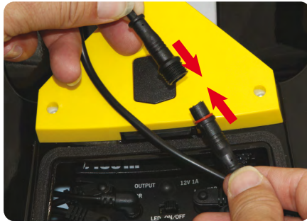
C. Kabel kamery zaveďte do lodi skrze velký otvor v držadle na zádi lodi a zaveďte jej dopředu do prostoru pro akumulátor, kde jej propojte s vodotěsným konektorem.
