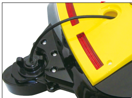
E. Sensor sonaru upevníte do držáku na zádi lodi. Kabel senzoru do lodi zavedte skrze velký otvor v držadle lodi.
